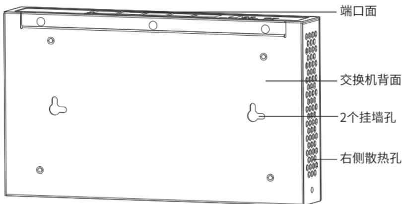
图2-1 挂墙孔示意图
